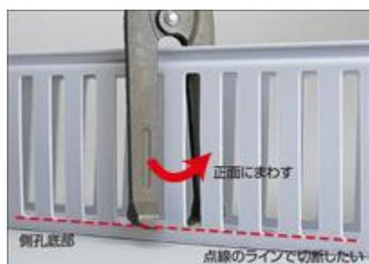
1. 刃先を側孔の底部にあてます。少しくわえた状態で正面にまわします。
