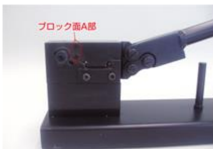
①ブロック面A部のネジを取り外してください。
